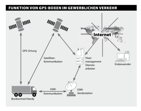
Die kombinierten Navigations- und Kommunikationsboxen ermöglichen die lückenlose Information über Geschwindigkeit, Kilometerstand, Standzeiten, die gesamte Fahrzeit und – auf Wunsch auch einzeln aufgeschlüsselt – die Fahrzeiten pro Auftrag und wie lange der Fahrer zwischen zwei Aufträgen fahren musste. Es ist zu sehen, wann die Arbeitnehmer Pause machen und wann sie Ihre Arbeit beenden.
